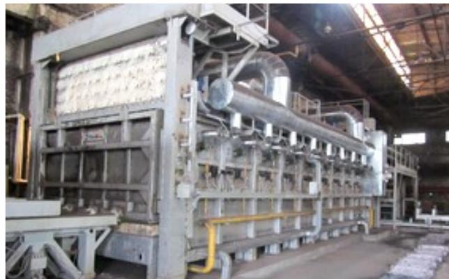
**Описание:** Проходная газовая печь непрерывного действия с двухрядным расположением поддонов разработана и изготовлена специалистами ЧАО «Керамаш» как автономно работающий агрегат, так и агрегат, работающий в составе закально-отпускного комплекса. Заказчиком был выбран бюджетный вариант печи, с применением нестандартных схем нагрева изделий, позволяющих получить выравнивание температуры садки при выдержке.
