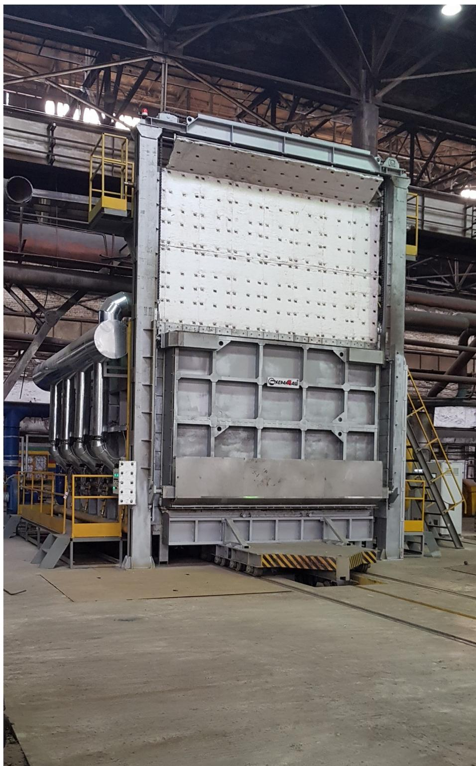
Рисунок №1 : Общий вид нагревательной печи после модернизации.
