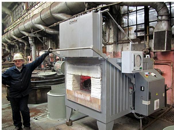
Разводка электрическая состоит из щита управления, жгутов проводов и прочего оборудования. Щит управления предназначен для монтажа приборов с цифровой индикацией, силовой аппаратуры, органов управления и сигнализации. Входящий в состав системы управления многоканальный бумажный самописец фиксирует на диаграммной бумаге график термообработки. Щит управления предназначен для установки в помещении с температурой эксплуатации +5...+35°C.
